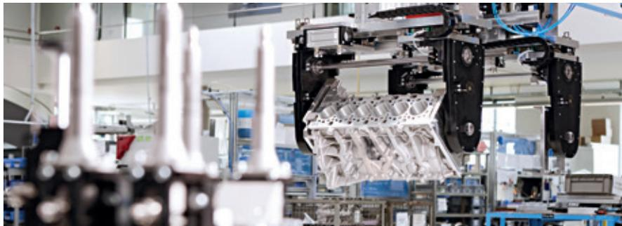
**Composants de systèmes.** Nous adaptons vos composants, comme l'équilibrage d'axe, les pinces ou les mors pivotants servomotorisés, à votre application spécifique dans les domaines de la technique de manutention, d'amortissement, de machines, de serrage et de freinage.
