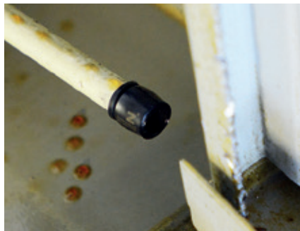
加工中心内的机门缓冲装置
