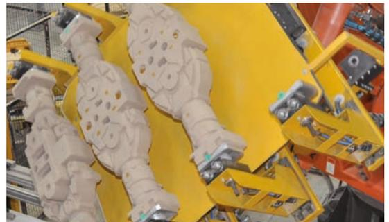
Système de préhension et de montage pour noyaux en sable / Retrait de la machine à noyauter
