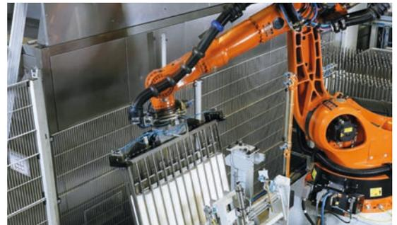
Système de préhension pour pots de yaourt (de différents diamètres) / Prélèvement sur la machine d'emboutissage et conditionnement en cartons
