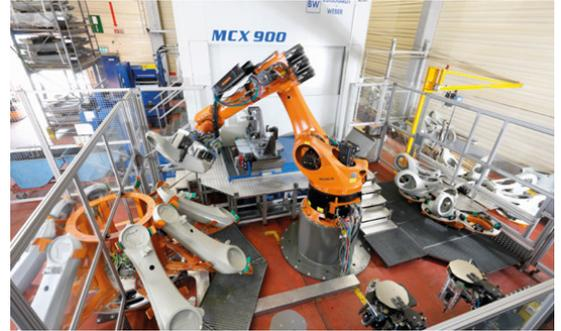
Système de préhension avec changeur d'outil pour pièces moulées et broche d'ébavurage / Chargement et déchargement de centre de traitement
