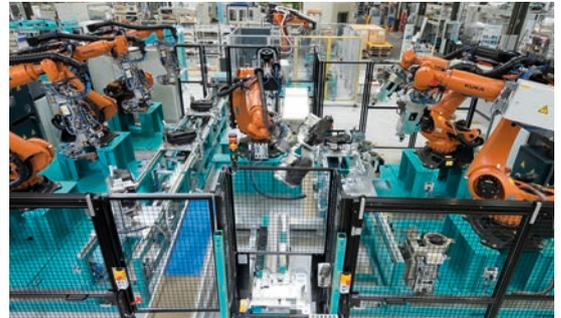
Système de préhension pour les réservoirs de carburant / Chargement de différentes stations de traitement
