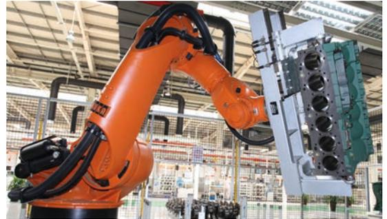
Système de préhension pour bloc moteur (600 kg) / Chargement et déchargement de stations de montage
