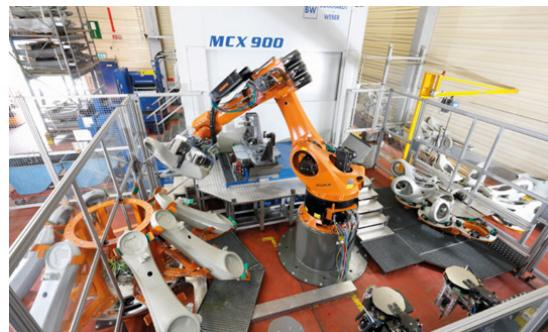
Manipulačný systém vrátane meniča nástrojov pre odliatky a odhrotovacie vretená / nakladanie a vykladanie obrábacieho centra
