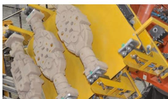
Manipulačný a montážny systém pre pieskové jadrá zo stroja na vstreľovanie jadier
