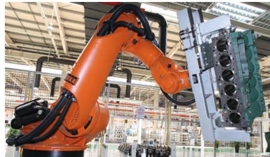
Manipulačný systém pre blok motora (600 kg) / nakladanie a vykladanie montážnych stanic
