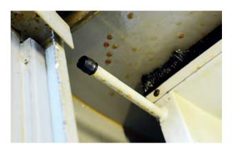
Dämpfung der Maschinentür in einem Bearbeitungszentrum
