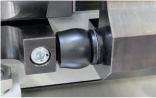
Notstopp-Schutz in der Verfahrachse eines Spindelreitstocks
