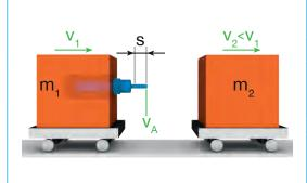
Geschwindigkeit des gesamten Objekts (beide Massen zusammen) nach dem Aufprall:
