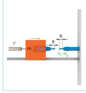
Bei n Stoßdämpfer in Reihe, n-fache Energieaufnahmekapazität durch n-fachen Hub bei gleicher Kraft.
