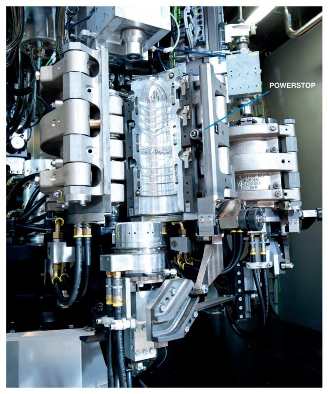
Sanfte Schließung der Streckblasformen durch PowerStop HighEnergy Dämpfer in Anlagen zur Herstellung von PET-Flaschen der Fa. Krones
