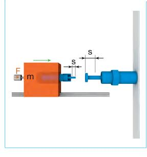
Kaskadenschaltung eines kleinen Stoßdämpfers, der auf einen größeren Stoßdämpfer auftrifft:
