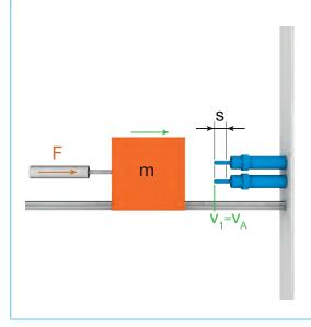
Bei n Stoßdämpfer parallel, n-fache Energieaufnahmekapazität durch n-fache Kraft bei gleichem Hub.
