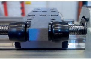
Endlagendämpfung in den Linearachsen von Fertigungsmodulen der Firma ELHA
