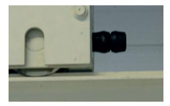
Notstopp-Dämpfung an einem Portalkran
