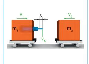
Geschwindigkeit des gesamten Objekts (beide Massen zusammen) nach dem Aufprall:
