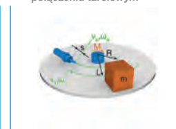
R7. Masa obracająca się poziomo z momentem napędowym przy połączeniu tarciovym
