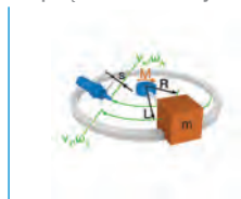
R6. Masa obracająca się poziomo z momentem napędowym przy połączeniu kształtowym
