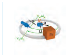
R6. Masa kývajúca sa horizontálne s kladným hnacím momentom
