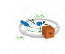
R6. Masa kývajúca sa horizontálne s kladným hnacím momentom
