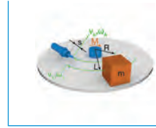
R7. Masa kývajúca sa horizontálne s trecím hnacím momentom
