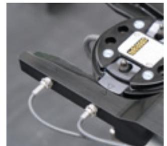
La estación de reposo dispone de un conjunto opcional de sensores. Junto con la señal Connect de serie, se garantiza un sistema 100 % seguro. Como complemento, en la parte fija también hay un indicador LED óptico.
