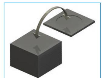
Les préhenseurs à ventouses se placent verticalement ou horizontalement sur une pièce à usiner devant être déplacée verticalement, respectivement retournée.
