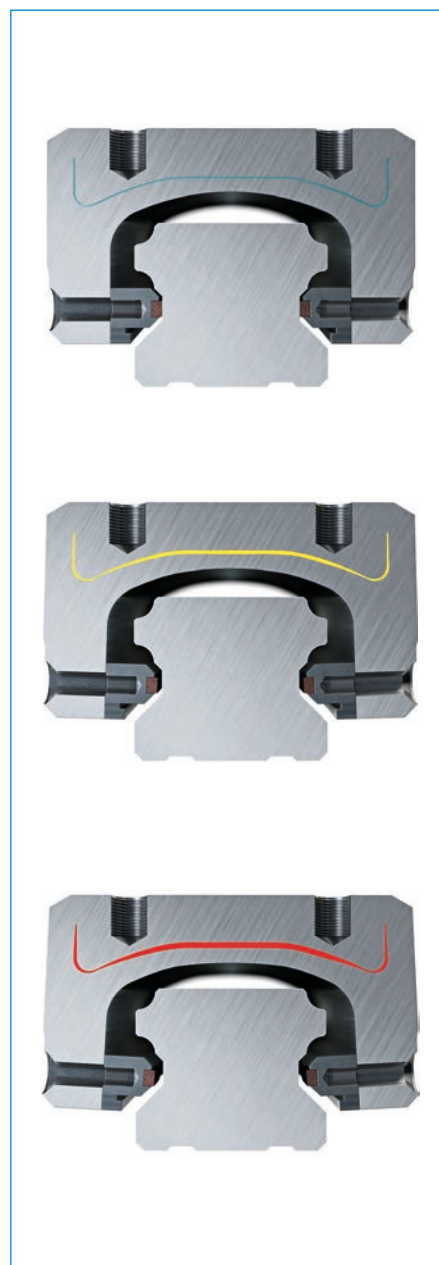
Figura 2: Funcionamiento de la serie LBHS en aplicación con presión hidráulica. Figura superior: "cerrado"; centro: "abrir"; abajo: "abierto"
