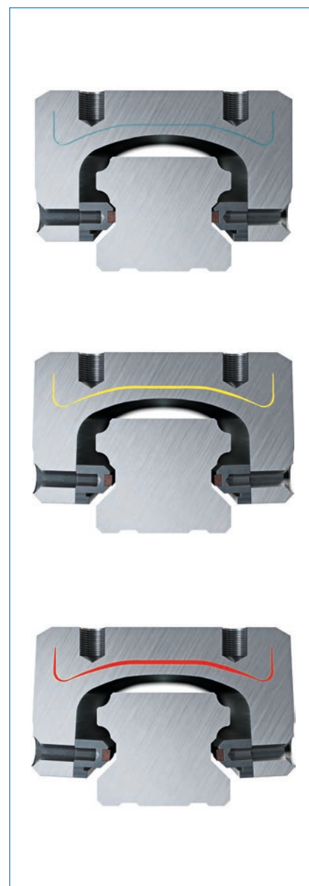
Immagine 2: Ciclo funzionale di LBHS con alimentazione a pressione pneumatica. Immagine superiore: "chiuso"; Centro: "aprire"; sotto: "aperto"
