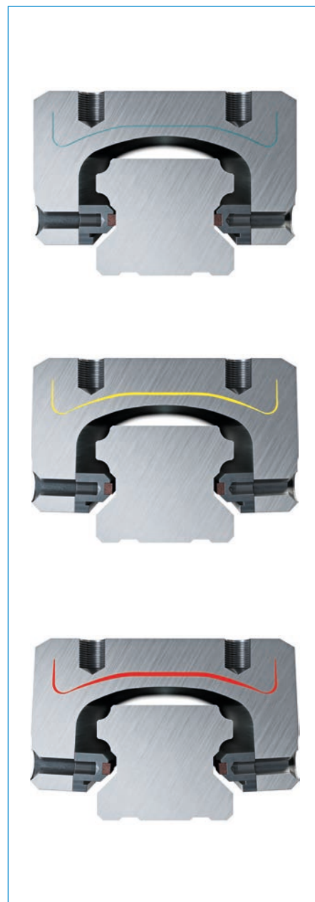
Rys. 2: Sposób działania LBHS przy zasileniu ciśnieniem hydraulicznym. Ilustracja u góry: „zamknięty” na środku: „otwieranie”; na dole: „otwarty”
