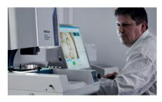
Appareil de mesure optique pour déterminer les dimensions du calibre de contrôle de vos composants.
