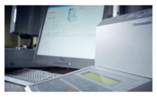
Pycnomètre à gaz pour mesurer la masse volumique du matériau sur vos composants en série.
