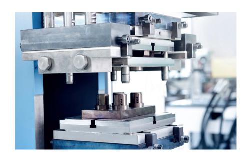
Outre le procédé de moulage par transfert au cours duquel l'élastomère est introduit dans un outil, moulé par compression à l'aide d'un poinçon et vulcanisé sous l'action de la pression et de la chaleur, nous avons également recours au procédé de moulage par injection-transfert. Dans ce cas, les matières brutes sont moulées par compression dans l'outil sur une machine de moulage par injection où elles sont complètement vulcanisées.
