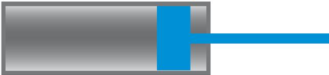
Dämpfer **mit** integrierter Rückstellung können ohne Kopplung in einen Beschlag eingesetzt werden, sie fahren selbständig aus.
