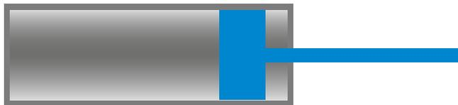
Los amortiguadores **con** retorno integrado pueden utilizarse sin acoplamiento en una guarnición, puesto que se extienden automáticamente.
