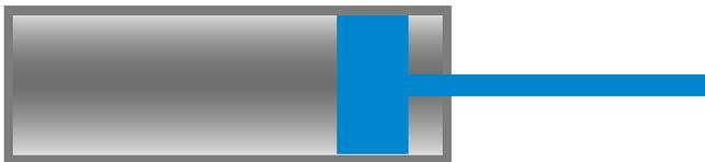
Les amortisseurs **avec** retour à la position initiale intégré peuvent être utilisés sans liaison dans une charnière et sortent automatiquement.
