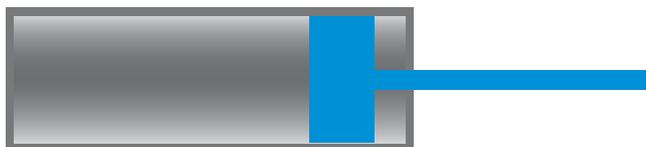
Dämpfer **mit** integrierter Rückstellung können ohne Kopplung in einen Beschlag eingesetzt werden, sie fahren selbständig aus.
