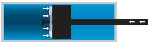
Amortyzator podczas ruchu roboczego
