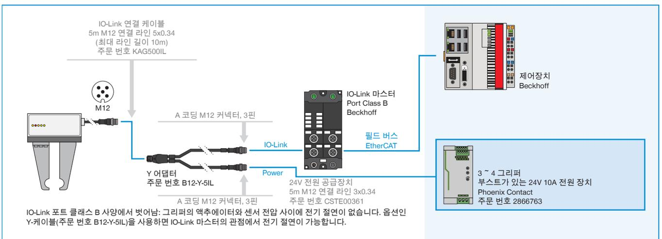
▶ Y 케이블을 통해 IO 링크 마스터 IP67에 연결된 GEH6000IL-03-B 배선(SIEMENS)
