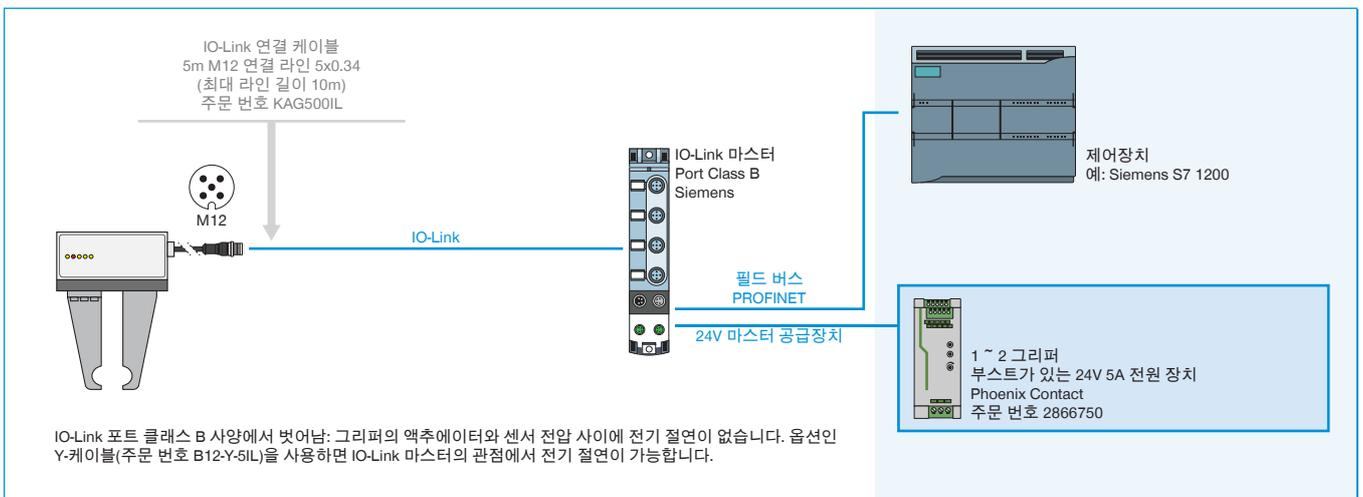
▶ Y 케이블을 통해 IO 링크 마스터 IP67에 연결된 GEH6000IL-31-B 배선(SIEMENS), 3-4 그리퍼
