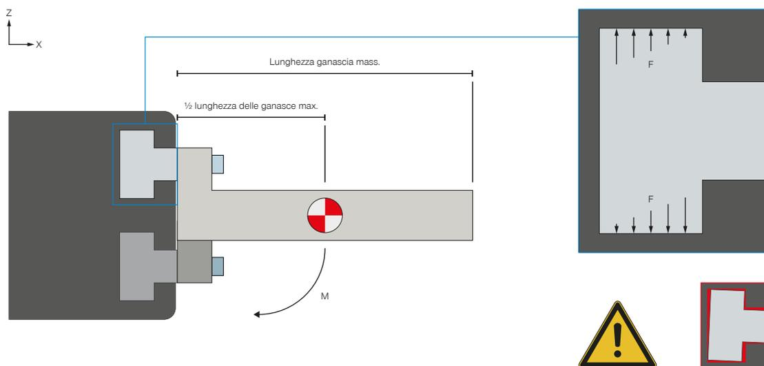
$$M_{max} = \frac{1}{2} \text{ lunghezza della ganascia max.} \cdot \text{peso proprio della ganascia montata max.} \cdot g$$
