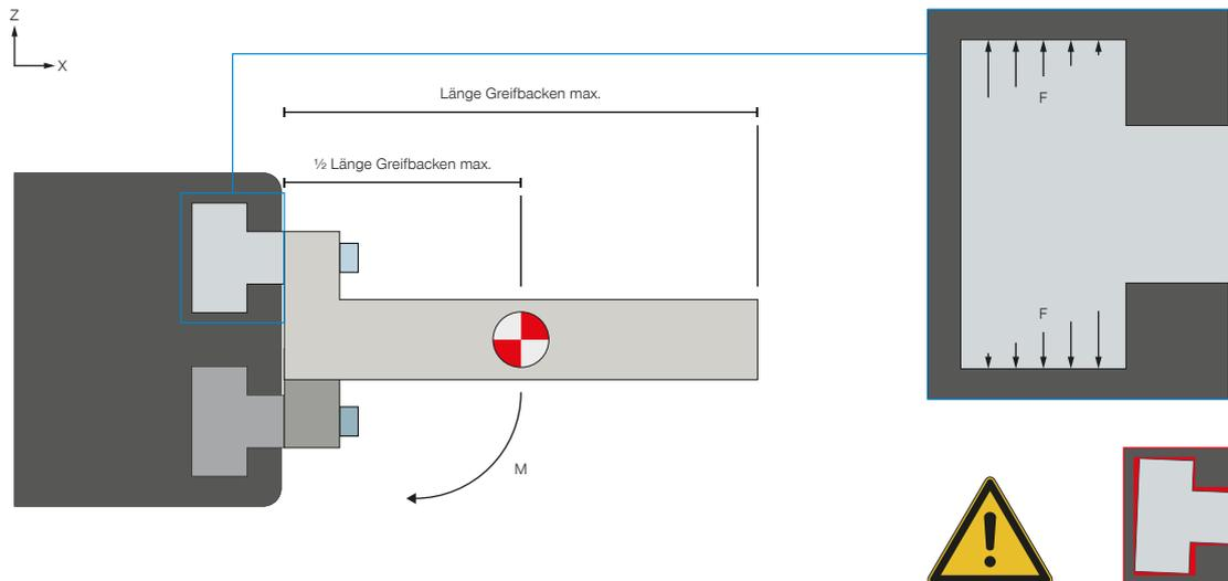
$$M_{\max} = \frac{1}{2} \text{ Länge Greifbacken max.} \cdot \text{ Eigengewicht montierte Greifbacke max.} \cdot g$$
