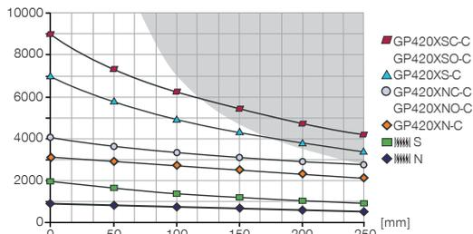
Getönte Fläche: es ist mit erhöhtem Verschleiß zu rechnen - evtl. Druck mindern
