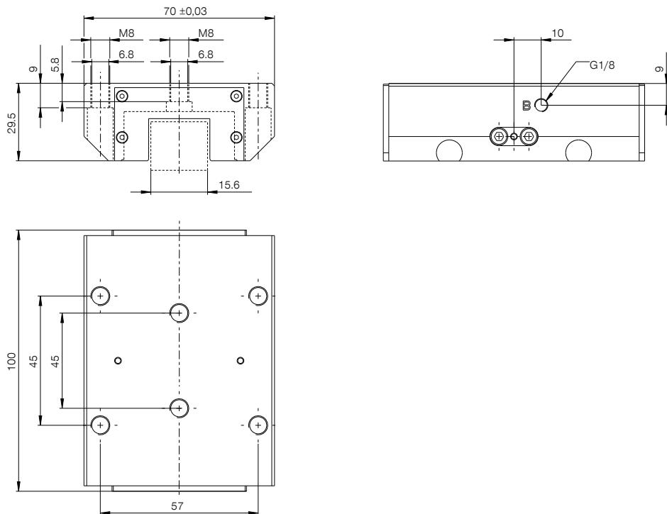
(B) Chiusura del collegamento (possibile su entrambi i lati, è necessario un solo collegamento)
