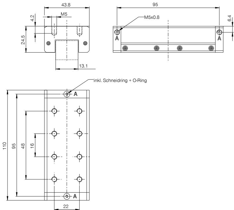
(A) Conexión abierta (posible en ambos lados, sólo es necesaria una conexión)
