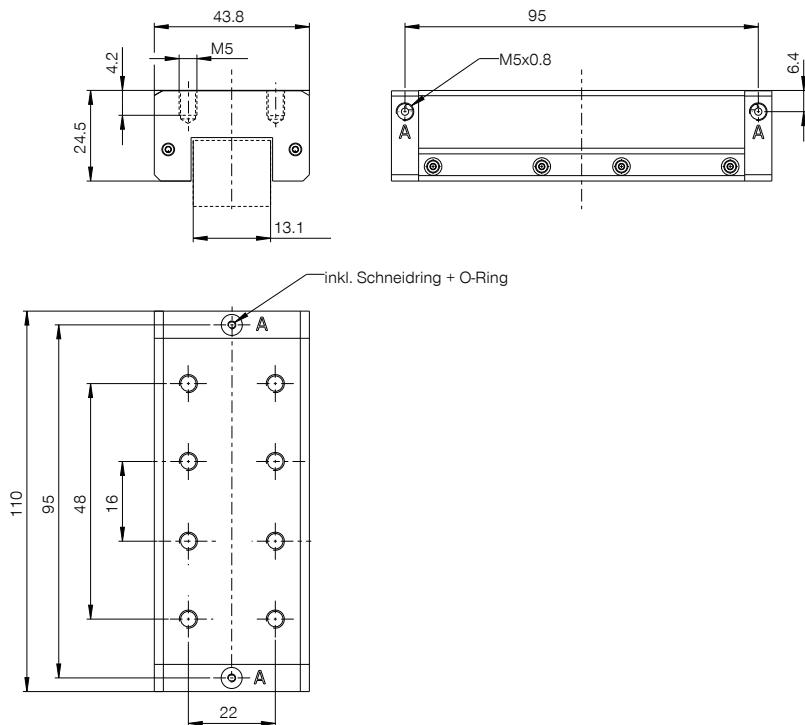
(A) Collegamento aperto (possibile su entrambi i lati, è necessario un solo collegamento)
