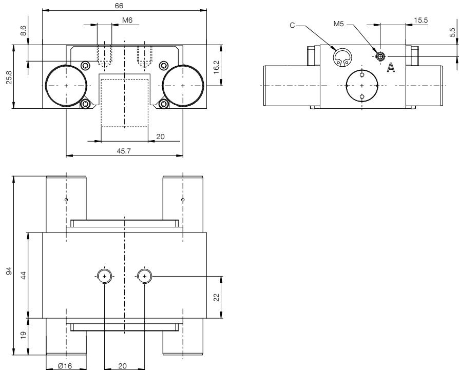
(A) Collegamento aperto (possibile su entrambi i lati, è necessario un solo collegamento)
