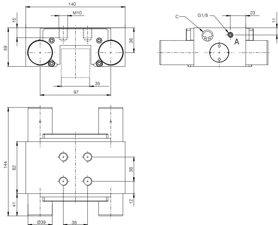
Ⓐ Raccordement Ouvrir (possible des deux côtés, un seul raccordement nécessaire)
