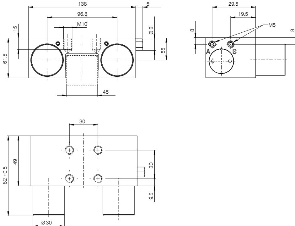
(A) Raccordement Ouvrir (possible des deux côtés, un seul raccordement nécessaire)
