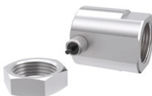
스톱 슬리브 특성 외에도 센서 스톱 슬리브에는 설정된 댐핑 스트로크의 끝 위치를 모니터링 하기 위한 초소형 인더티브 센서가 장착되어 제공됩니다. 센서 스톱 슬리브를 사용 하려면 강철 또는 플라스틱 헤드가 장착된 산업용 속압쇼바를 사용해야 합니다(벨로우즈 제외).
