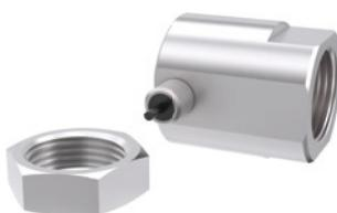
스톱 슬리브 특성 외에도 센서 스톱 슬리브에는 설정된 댐핑 스트로크의 끝 위치를 모니터링 하기 위한 초소형 인덕티브 센서가 장착되어 제공됩니다. 센서 스톱 슬리브를 사용하려면 강철 또는 플라스틱 헤드가 장착된 산업용 속압쇼바를 사용해야 합니다(벨로우즈 제외).
