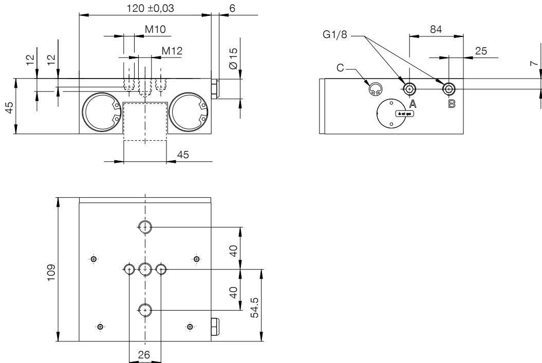
(A) Conexión abierta (posible en ambos lados, sólo es necesaria una conexión)
