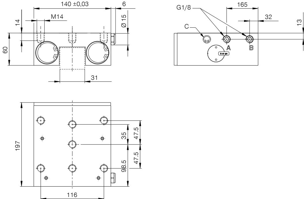
(A) Collegamento aperto (possibile su entrambi i lati, è necessario un solo collegamento)
