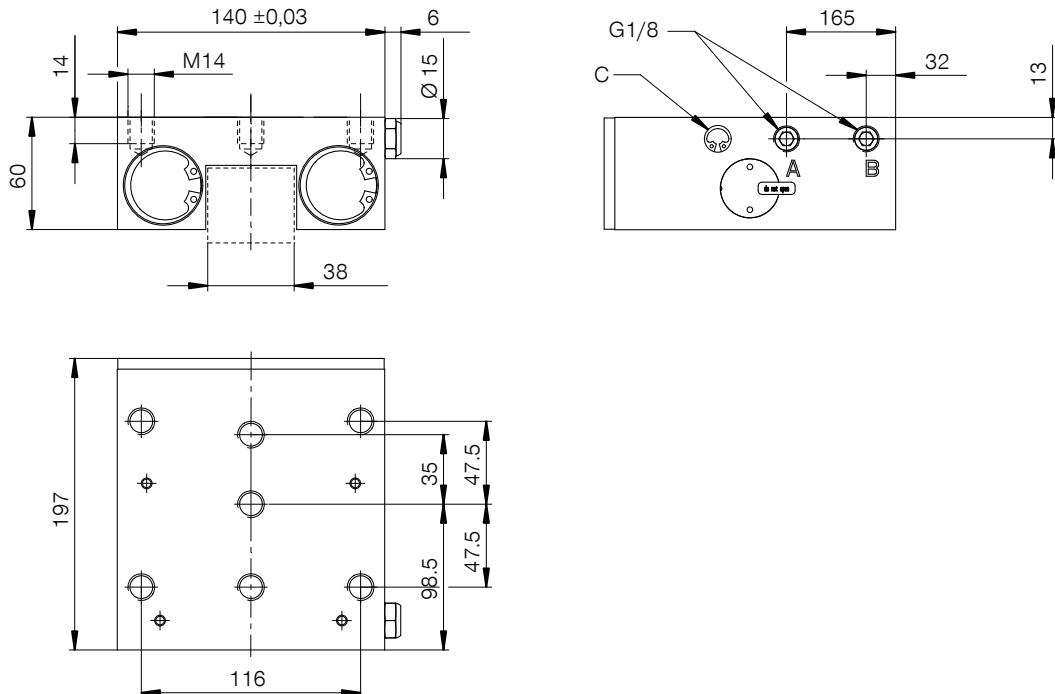
(A) Anschluss Öffnen (beidseitig möglich, nur ein Anschluss notwendig)
