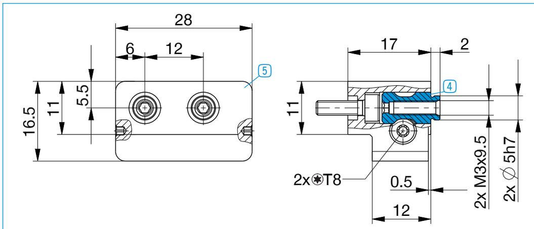
Per ogni ganasca è necessario un set di parti mobili del cambio rapido ganasce 4 e una parte fissa del cambio rapido ganasce 5
