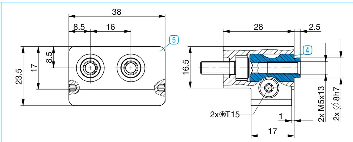
Pro Greiferbacke wird jeweils ein Wechselbacken-Losteil-Set (4) und ein Wechselbacken-Festteil (5) benötigt
