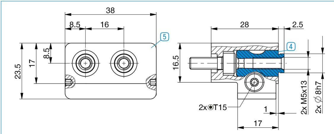
Per ogni ganasca è necessario un set di parti mobili del cambio rapido ganasce 4 e una parte fissa del cambio rapido ganasce 5
