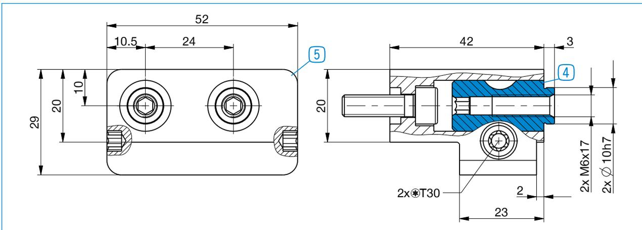
Pro Greiferbacke wird jeweils ein Wechselbacken-Losteil-Set (4) und ein Wechselbacken-Festteil (5) benötigt
