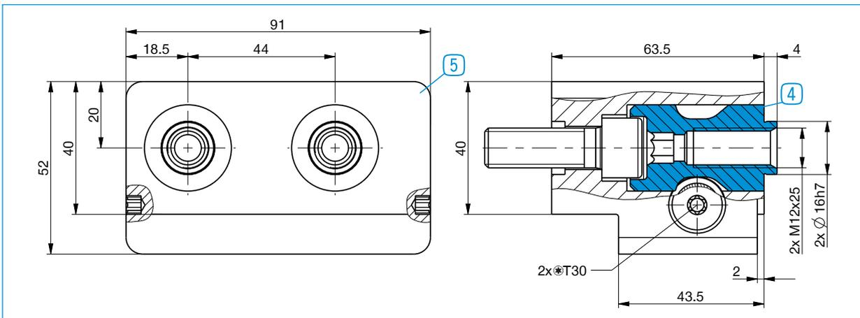
Pro Greiferbacke wird jeweils ein Wechselbacken-Losteil-Set (4) und ein Wechselbacken-Festteil (5) benötigt
