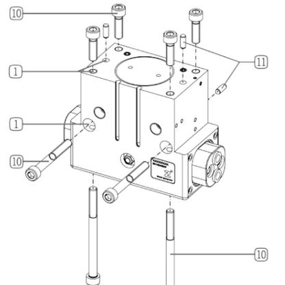
Der Greifer kann von mehreren Seiten montiert werden. Entweder direkt am Greifer oder an der Anschlusskonstruktion.
